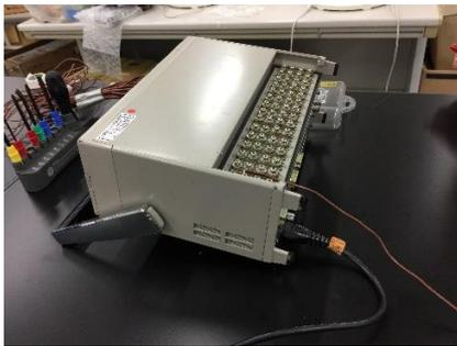
(d) data logger of thermocouple
