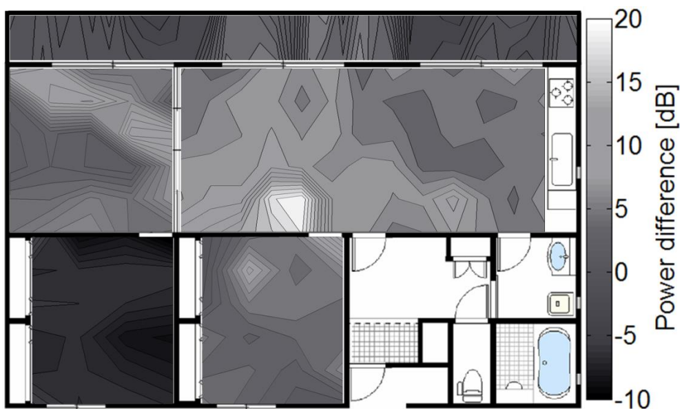
図 5.6 各測定点における差分スペクトルの最大値の空間分布
