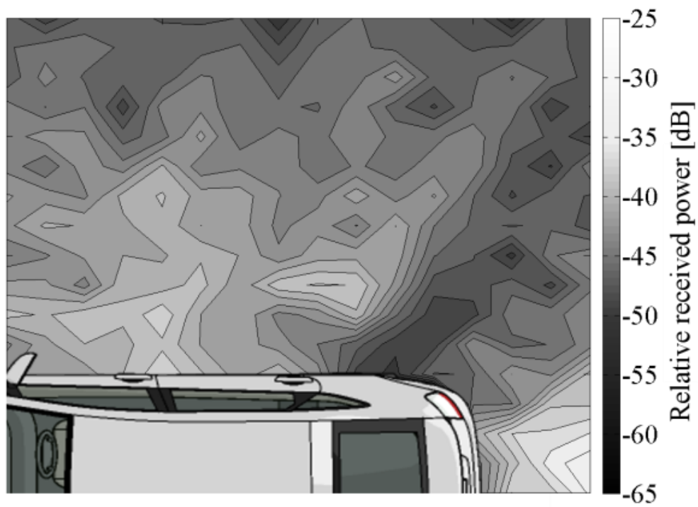
図 3.17 マイクロ波帯の車外への漏えい電力分布
