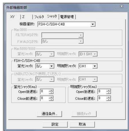
Fig.3.3 シャッターの制御画面 (Luminavision)
