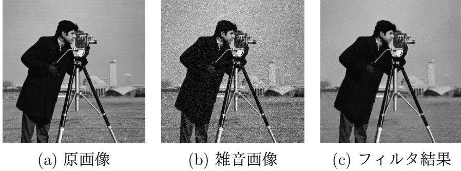
図 3.5: ノンローカルミーンフィルタによる雑音除去. 各パラメータは \sigma = 0.1 , フィルタサイズは |\mathcal{N}_1| = 21 \times 21 , 類似度を測る際の局所領域サイズは |\mathcal{N}_2| = 3 \times 3 である.
