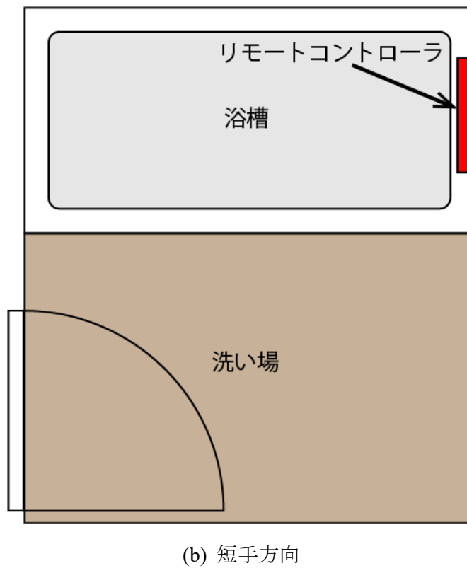
図 5.3. 浴室のモデルとリモートコントローラの設置位置
